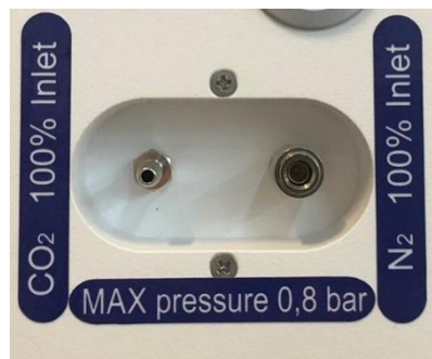
Figuur 11.1 Gasinlaten aan de achterkant van de MIRI® II-12 IVF incubator met meerdere kamers
