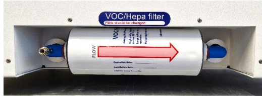
Figuur 12.3 Correct geïnstalleerd VOS/HEPA filter
